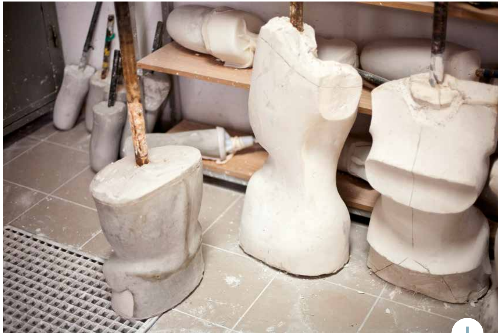
A PROTÉZISEKET MINTAVÉTEL UTÁN GIPSZBŐL KIÖNTIK
